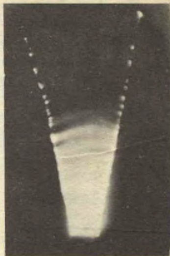
Nutrita scarica ad arco tra due conduttori divergenti
