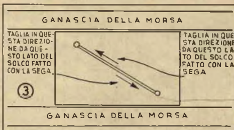
Fig. 1 e 2. - Come si esegue la scanalatura per l'incasso del conduttore nel rovescio della base con il saracco e lo scalpello
