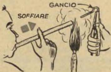
3. - Si continui a scaldare diminuendo la fiamma, sino a quando la saldatura vetro-metallo sia pressochè fredda. Quindi con la fiamma a punta diretta verso il centro del tubo, si porti qui a color rosso una piccolissima zona e, soffiando dalla parte libera, si provochi il formarsi di una bolla, che, una volta fredda, si distruggerà con un piccolo colpo di pinza.
