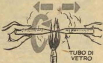
2. - Si prepari un gancio di filo di ferro dello spessore di mm. 1,5 e della lunghezza di circa cm. 2. Si porti il tubo alla fiamma e, soffiando nella estremità ancora aperta, si faccia arrotondare quella prima chiusa. Contemporaneamente si scaldi (tenendolo con una pinzetta) il gancetto di ferro ed allorché questo ed il tubo saranno giunti a color rosso, s'introduca la parte dritta del gancio nel tubo di vetro.
