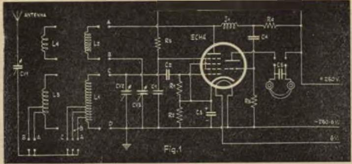
Fig. C - Lo schema del ricevitore per onde corte
