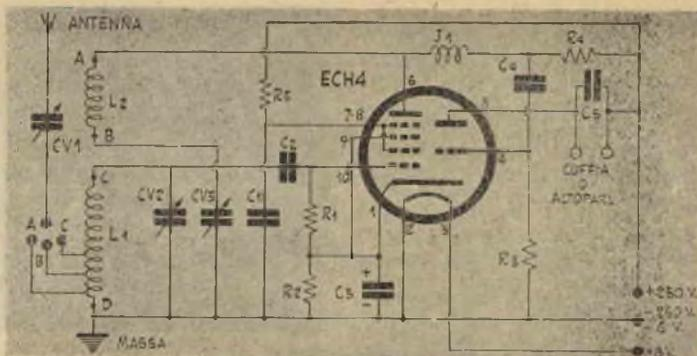
Fig. B - Il ricevitore allo stadio iniziale applicare alla griglia della seconda sezione (triode della valvola).
