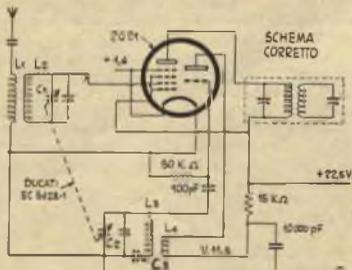
va certo attribuito alla parte oscillatrice vera e propria. Cioè, se la valvola è efficiente, l'oscillatore indubbiamente oscilla, ma non sulla frequenza voluta. Esempio, supponiamo che la frequenza sia di 470 K. Per ricevere le Onde Medie,
