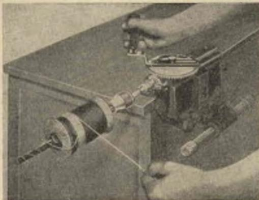
Fig. 2 - Il trapano in veste di bobinatrice
