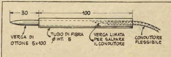
Fig. 3 - Terminali per un prova circuiti
