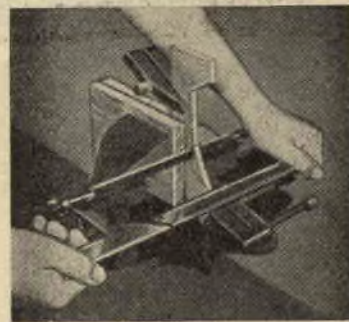
Fig. 5 - Per l'ultimo taglio i pezzi vanno ancora spostati, i morsetti portati a serrare vicino alla linea del taglio e la lama fatta roteare nel telaio. Sarà così facile asportare il pezzo triangolare.
