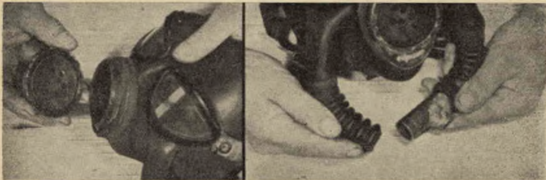
3 - Diaframma di caucciù, anello, disco di metallo e ritegno del diaframma sono quindi riuniti l'uno all'altro ed il tutto viene avvitato nuovamente al suo posto. Le estremità del riduttore a T sono poi inserite nelle estremità dei tubi corrugati, come mostrato in fotografia.
