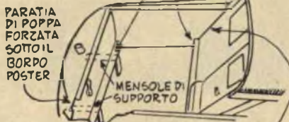
LA PARATA DELLA CABINA È SALDATA AI FIANCHI DELLO SCAFO
