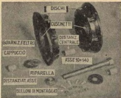
4 - Preparazione del mozzo della ruota - I cuscinetti sono a posto nei cerchioni. Il distanziatore centrale deve esser serrato contro gli anelli interni dei cuscinetti, la cui vite è prolungata da guarnizioni di feltro. Bulloni e dadi tengono unito il mozzo.
