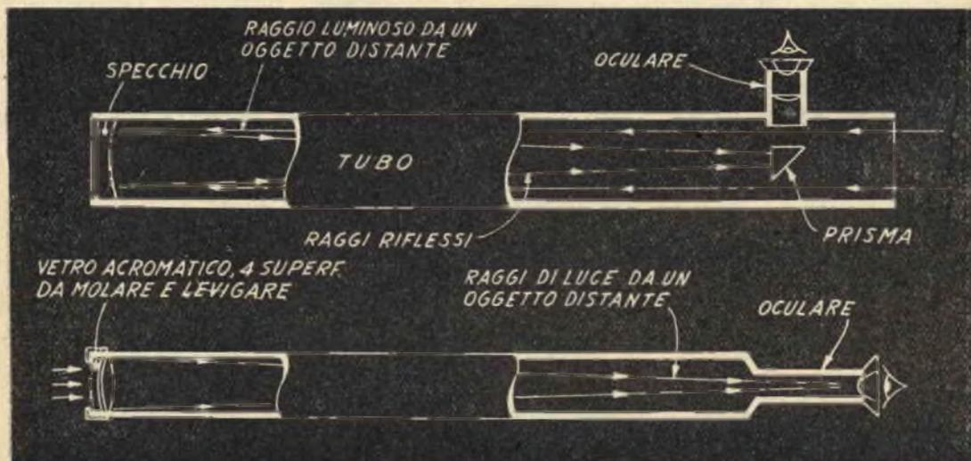
Uno strumento a riflessione ha solo una superficie otticamente levigata, contro le quattro degli strumenti a rifrazione. Tutti i più grandi telescopi moderni sono a riflessione, compreso quello di Monte Palomar.
