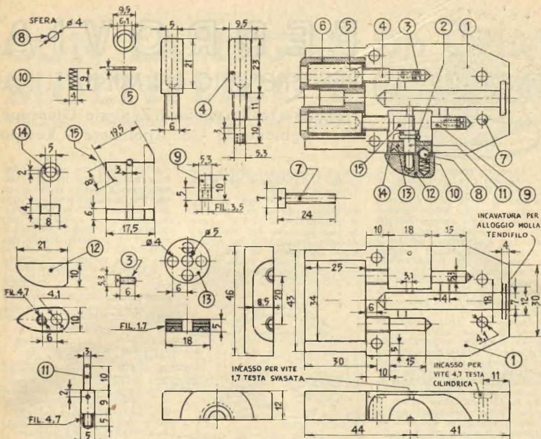
tornio con autocentrante a 4 ganasce, sia con il trapano, usando una punta a scalino. Lo stesso dicasi per l'alloggio dell'interruttore. Le tre operazioni non presentano alcuna difficoltà.
