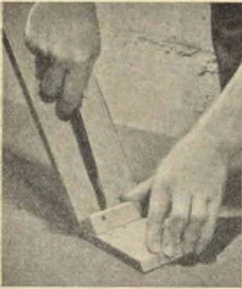
Come si avvitano definitivamente i rinforzi all'interno degli spigoli della cornice
