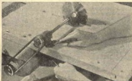
Albero, supporti antifrizione, motore, cinghia di trasmissione e lama della sega è tutto quanto occorre acquistare. Il motore può essere di seconda mano.
