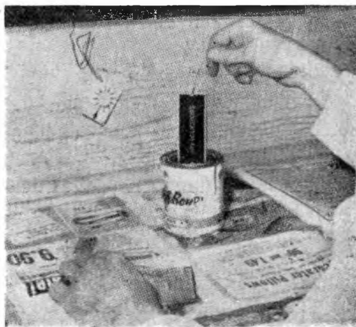
La targhetta già ultimata e smaltata viene immersa in lacca trasparente per preservare e rendere più duratura la finitura, conservandole la lucentezza
