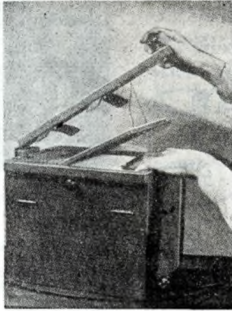
Fig. 1. - Il braccio di legno apre e chiude il coperchio della scatola.
