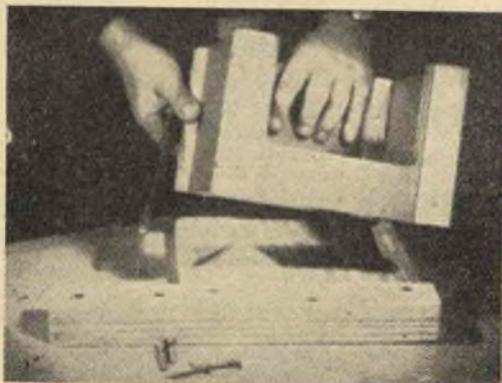
**PER FARE** il corpo dell'utensile unite le fiancate di faesite con cornici a sezione angolare e correntini di rinforzo da sistemare nell'interno, in modo che la faesite rimanga incastrata tra questi e le superfici interne delle cornici. Il pannello aperto permette l'accesso al dispositivo per il sollevamento e l'abbassamento della lama e consente la facile rimozione della segatura accumulatasi nell'interno.
