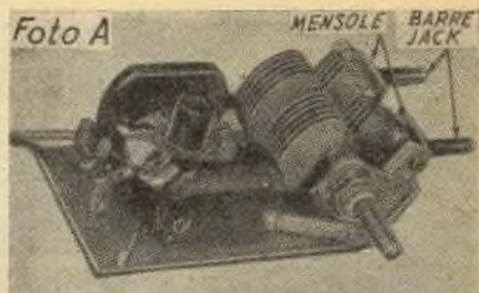
Foto A - Particolare del montaggio dell'oscillatore, illustrante il montaggio dei jacks sul variabile
