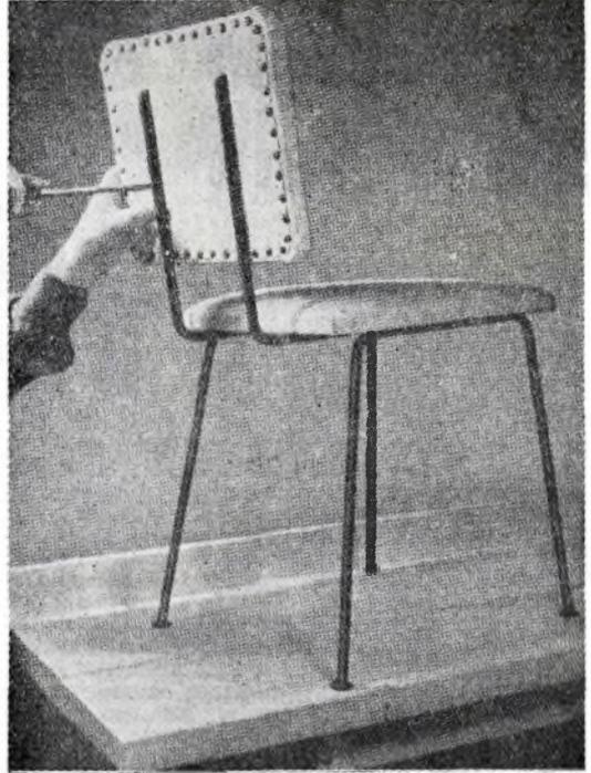
Fig. 6. - Il montaggio della seggiola viene ultimato fissando con le apposite viti sedile e spalliera.
