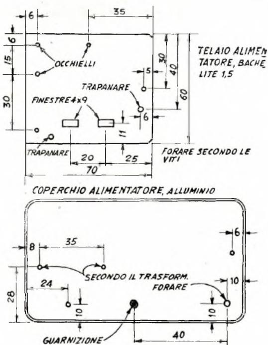
L'ALIMENTATORE DELL'ALTOVOLTAGGIO ha due valvole montate in zoccoli miniatura. Caucciù spugnoso nella cossetta preme contro gli involucri di vetro. Una estremità di C2 va al contatto « caldo » del vibratore (quello con il filo rosso). Il filo giallo e una estremità di R1 vanno alla linguetta massa, sotto il bulione-nucleo del trasformatore.
