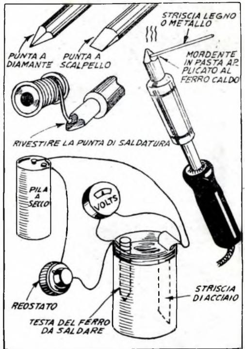
secondo le indicazioni della nostra illustrazione, mediante una grossa pila a secco, un reostato ed un voltmetro, il quale, se non è essenziale, può tornare di grande utilità, permettendo di controllare continuamente le condizioni elettriche del bagno.
