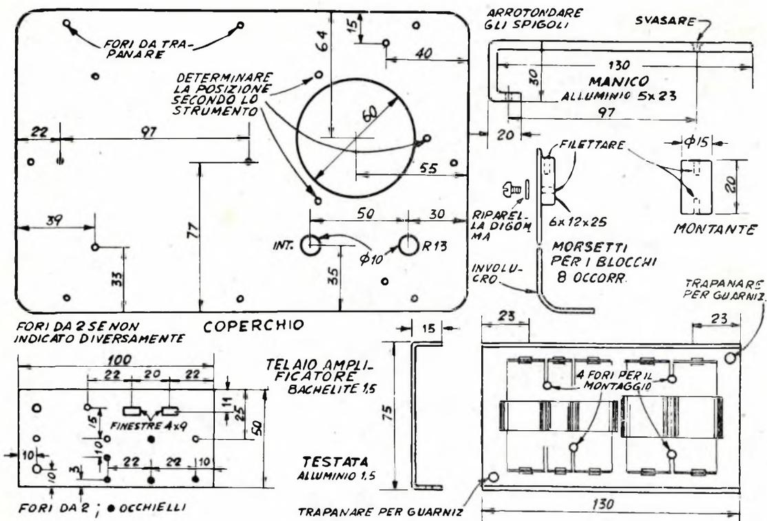
TRACCIATE ED APRITE il foro per il quadrante ed i fori di montaggio dello strumento, servendovi dello strumento stesso come guida. La grande apertura può esser fatta con un taglia-fori, un sega-fori o un seghetto da gioielliere. Il compatto amplificatore è montato sul suo telaio e questo montato sul sottopannello
