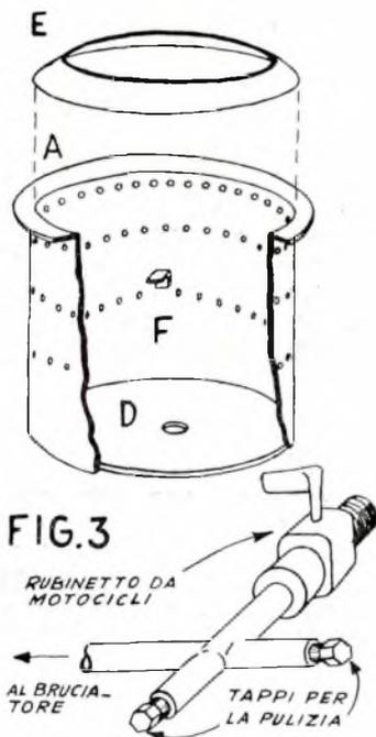
stufa, sulla quale si appoggia (per essere sicuri di questa tenuta basta impastare un poco di cemento refrattario e riempire fra la flangia del bruciatore ed il corpo della stufa).
