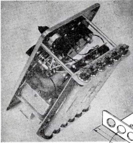
**MONTATE I TUBI DI GEIGER con anelli elastici.** Piegate a 90° i piedini n. 3 e leggermente meno i n. 1. I piedini n. 2 non hanno alcun collegamento. Saldate un condensatore da 47 mmfd ed una resistenza da 47.000 ohm attraverso i piedini 1 e 2 di ogni zoccolo. Collegate tutti i piedini n. 2 con un filo nudo e fate passare all'isolatore del sottopannello un filo isolato. Unite ugualmente i piedini n. 3 ed attraverso l'isolatore inviate all'amplificatore.
