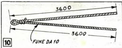
Fig. 10. - Quattro doppie funi, il cui anello s'impegna nella sporgenza dei montanti d'angolo, servono per l'ancoraggio della tenda ai picchetti infissi nel terreno
