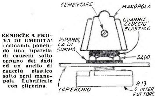
**RENDETE A PROVA DI UMIDITA'** i comandi, ponendo una riparella di caucciù sotto ognuno dei dadi ed un anello di caucciù elastico sotto ogni manopola. Lubrificate con glicerina.
