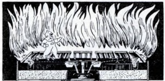
③ LE CORRETTE PROPORZIONI DELLA MISCELA NAFTA-ARIA SONO IMPORTANTISSIME AL FINE DI OTTENERE IL MASSIMO CALORE DAL COMBUSTIBILE.
