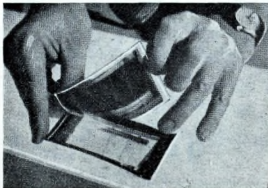
La negativa è disposta sulla positiva trasparente, le immagini debbono essere leggermente sfasate.
