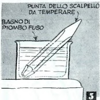
5 Riscaldando il fusto degli utensili nel bagno di piombo fuso nel modo indicato si riesce a controllare accuratamente il colore della punta da trattare.
