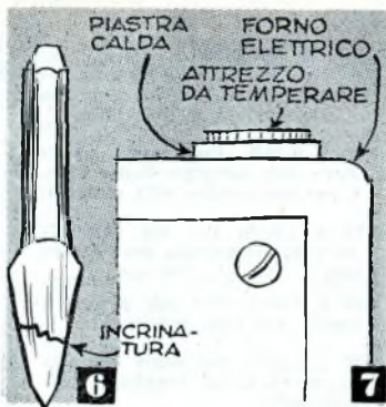
6 Tenendo fermo lo scalpello nell'acqua durante lo smorzamento si possono determinare delle rotture, dovute alle tensioni interne. Si può evitare ciò tenendo in continuo movimento l'acqua od il pezzo trattato.
