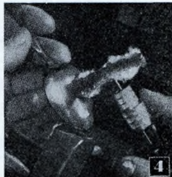
4 Una accurata detersione ed una buona lucidatura prima dell'argentatura sono indispensabili ove si desideri un ottimo risultato finale.
