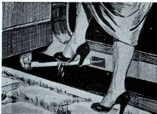
Un'asticella di metallo che consenta, ad apertura dello sportello della macchina, di raschiare dalle scarpe il fango e la terra appiccicata alle suole. L'interno della macchina sarebbe sempre più pulito.
