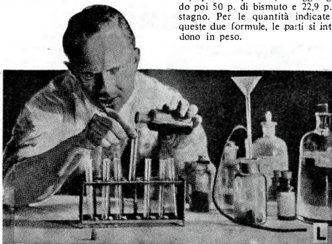
Interessante esperienza che mostra la presenza del pericolo di avvelenamento particolarmente nel caso che tubi di piombo vengano usati per le condutture di acqua potabile, e nel caso che in cucina si faccia uso di recipienti stagnati.
