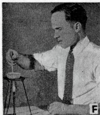
Essiccazione ed eliminazione dell'acqua di cristallizzazione del tartrato di piombo mediante il riscaldamento della sostanza in un recipiente di porcellana riscaldato ad esempio da un bruciatore di Bunsen
