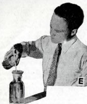
Versare lentamente nell'imbuto che contiene la carta filtro il liquido in cui il tartrato di piombo si trova in sospensione (e gli conferisce l'apparenza lattiginosa).
