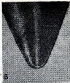
(A) Come appare al microscopio una puntina per microscolco nuova. (B) come appare, sempre al microscopio, una puntina per dischi a 78 giri, nuova. (C) Dopo una cinquantina di ore di uso, la punta di uno stiletto di zaffiro comincerà a perdere la sua rotondità e ad assumere, invece un profilo simile a quello di uno scalpello. (D) Dopo 100 ore di uso, la punta sarà stata sostituita da un filo piatto, molto tagliente, che oltre a produrre degli indesiderabili rumori ed a diminuire la resa, specie delle frequenze alte, danneggerà irrimediabilmente i dischi.
