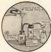
Produzione del gas solforoso, liquefazione e solidificazione di esso a bassissima temperatura.
