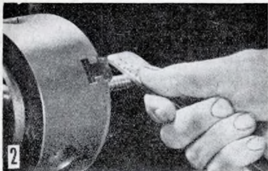
2 Uso della guida e di un tornio per l'avvolgimento di molle di qualsiasi passo, cioè, con qualsiasi distanza tra spira e spira. La guida va premuta contro la barretta fissata sul mandrino del tornio.
