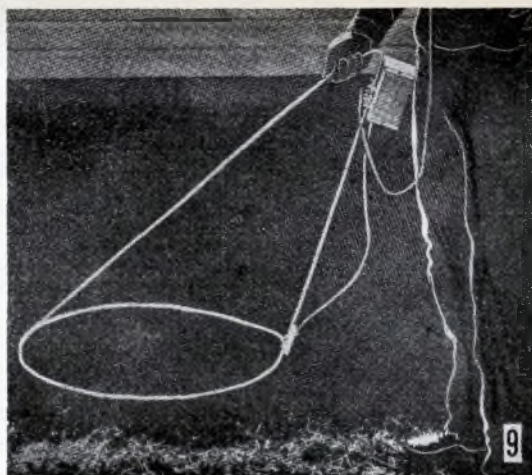
Altra veduta interna del cercametalli a quattro transistors. Il cercametalli a quattro transistors in funzione; notare la leggerezza.
