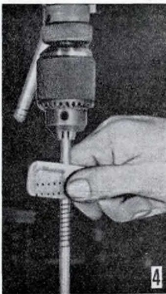
4 Avvolgimento di una molla con l'aiuto della guida universale e di un trapano a colonna, che va sempre fatto girare a velocità ridottissima.
