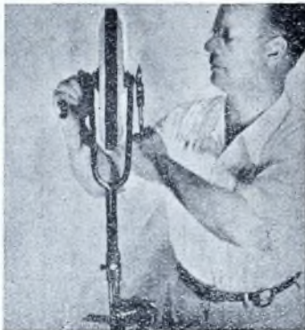
Uso di due chiavi girate in senso inverso, per stringere il dado e contemporaneamente trattenere immobile la testa del bullone. Osservare nella foto la perfetta centratura della ruota rispetto alla forcella.
