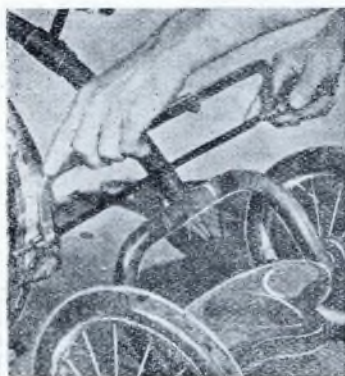
Con una sega a metallo si separa il ponte posteriore del telaio tubolare del triciclo, poco sopra al punto di unione tra il primo e l'estremità del secondo.
