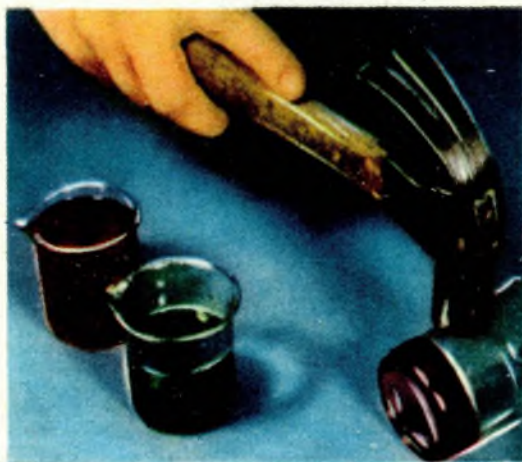
Foto in alto: Il blocchetto di plastica può essere segato, limato, intagliato, lavorato al tornio ecc., come se si trattasse di un pezzo di legno duro. Foto in basso: Rottura del recipiente di vetro per estrarre dal suo fondo la plastica che nel frattempo sarà indurita.
