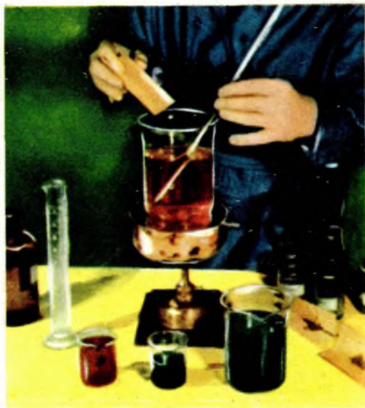
Aggiunta alla resina mentre questa si trova alla consistenza di un denso sciroppo, dei colori che si saranno scelti. I colori dovranno essere del tipo solubile negli olii.
