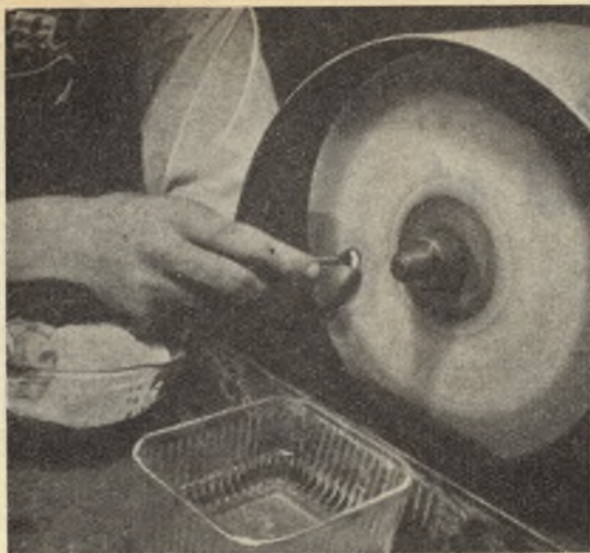
FOTO A SINISTRA: Stadio più avanzato della lavorazione: si sta lavorando con la mola a grana fine. FOTO A DESTRA: Queste sono le vicende di cui la pietra dura è la protagonista: dal blocco grezzo di minerale allo sfaldamento di questo secondo i piani di clivaggio, alla preliminare formatura dei blocchetti prima della lavorazione alla mola, allo scarabeo, già finito e lucidato, pronto per l'incastonatura.
