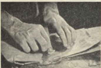
Passare sul metallo la tela smeriglio nella direzione indicata.
