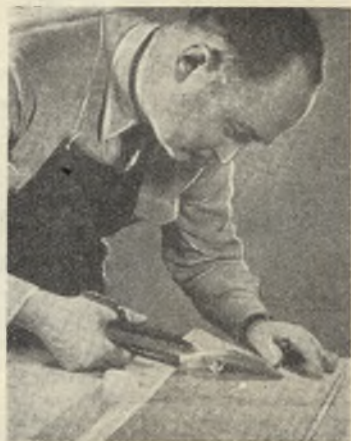
Gli elettrodi depuratori vanno ritagliati da una lastra di alluminio; la loro misura dovrà essere, per recipienti di un litro, di mm. 50 x 150; per recipienti da due litri di millimetri 50 x 225.
