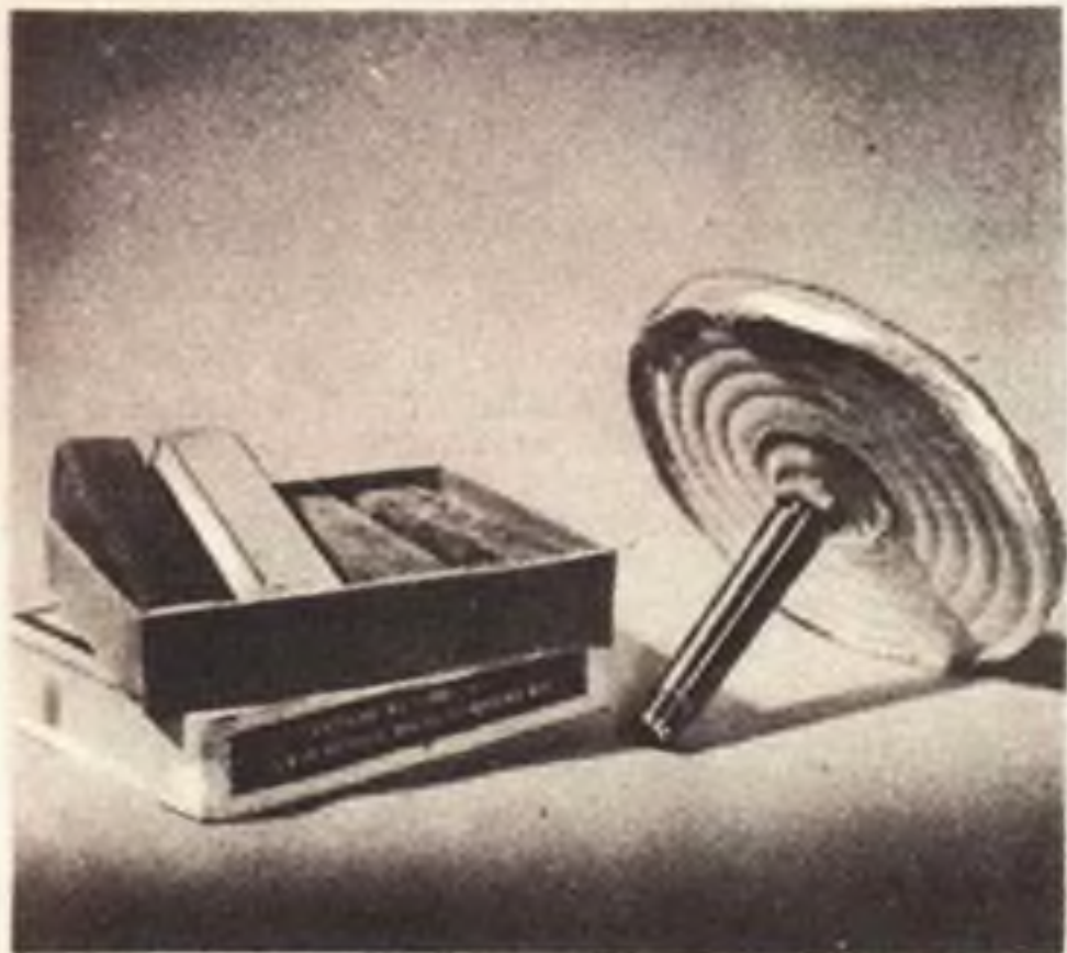
Una serie di blocchetti di pasta abrasiva, una ruota composta da più dischi di tela cuciti insieme, con al centro un alberino da stringere in un qualsiasi mandrino rappresentano tutta l'attrezzatura occorrente per l'esecuzione di lucidature su oggetti di metallo, con la certezza di successo.
