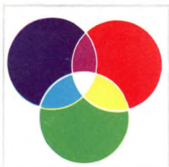
Fig. 1 - SINTESI ADDITTIVA (sovrapposizione di 3 luci colorate)
