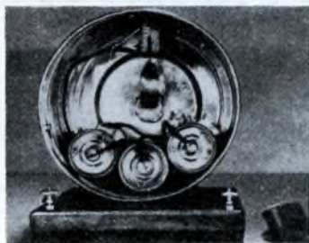
Veduta interna della scatola acustica, con le tre pile da 1,5 volt, sistemate al loro posto, tra le apposite staffette. All'esterno della scatola, in basso, a destra, è visibile uno degli spaziatori in cartoncino, di cui si parla nel testo.
