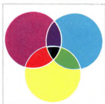
Fig. 3 - SINTESI SOTTRATTIVA (Sovrapposizione di 3 strati colorati)
