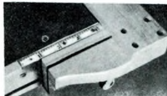
Guidalegno: la sua presenza facilita enormemente l'esecuzione di tagli perfettamente riusciti; agevola anche l'esecuzione di tagli paralleli.
