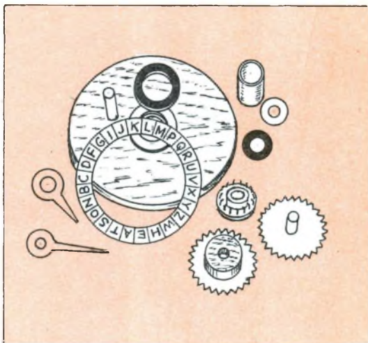
Queste sono le varie parti che entrano nella costruzione di questo apparecchio per la cifratura
