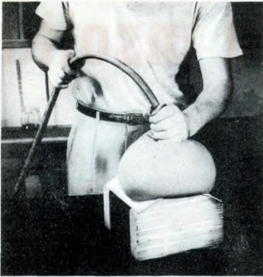
Utilizzazione del peso dell'acqua per sostenere una pressione dolce ed uniforme su di una superficie non piana. Il recipiente illustrato è un cuscino pneumatico da spiaggia.
