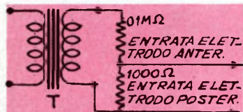
TRASFORMATORE DEL TRASMETTITORE
