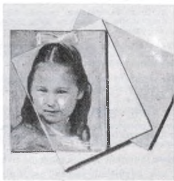
I tre elementi che compongono il wafer con cui si confezionano le foto da portafoglio: la diapositiva, il foglio di carta dorata e il cartoncino di rinforzo.
