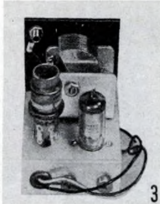
Veduta di fronte, del retro e del di sotto, del compatto ricevitore illustrato in questo articolo. Le sue dimensioni estremamente ridotte permettono di sistemarlo dovunque; l'alimentazione per esso consiste in una pila da 1,5 volt ed in due batterie da 22,5 volt, collegate in serie. Tali pile possono trovare posto in una scatola a parte, collegata all'apparecchio vero e proprio con un cavetto tripolare.
