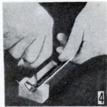
Ecco come le estremità delle guide inclinate vanno fissate ai blocchetti, nella apposita incisione a V.
