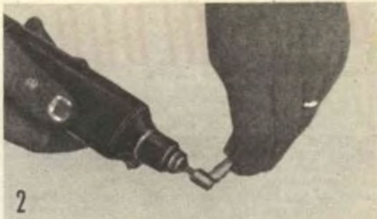
Foto 1 - Semplice saldatura di un filo di rame ad un pezzo di grafite, secondo la nuovissima tecnica, di recente scoperta ed illustrata nel presente articolo. Foto 2 - Prima operazione è quella del riempire di lega per saldare, le porosità della rotella abrasiva, fissata su di un utensile a motore; è bene che la lega sia ad alto tenore di stagno; ossia al 60% Sn ed il 40% Pb.
