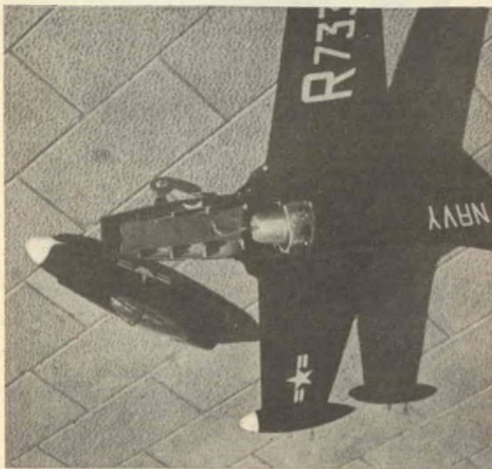
Una bella riproduzione del «Grumman Panther» eseguita da Riccio di Latina, con pulsoreattore interno alla fusoliera.
