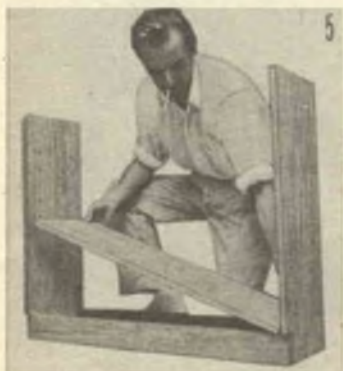
Se tutte le parti siano state tagliate secondo le misure indicate sia dei disegni che nell'elenco parti, si noterà, a questo punto, come il fondo vada con precisione al suo posto. Si inchiederà quindi il fondo sia all'elemento anteriore che a quello posteriore di base.
