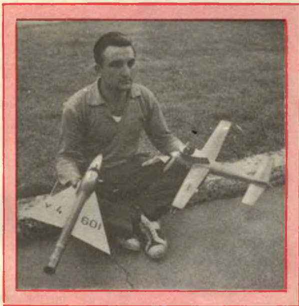
Il napoletano Podda, ora a Genova, mostra i suoi due ultimi modelli da velocità: quello a destra con motori alternativi, quello a sinistra con pulsoreattore ad ala a delta.
