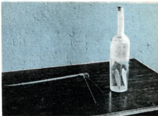
La fusoliera con i supporti della matassa, e le pale dell'elica in forma sulla bottiglia
