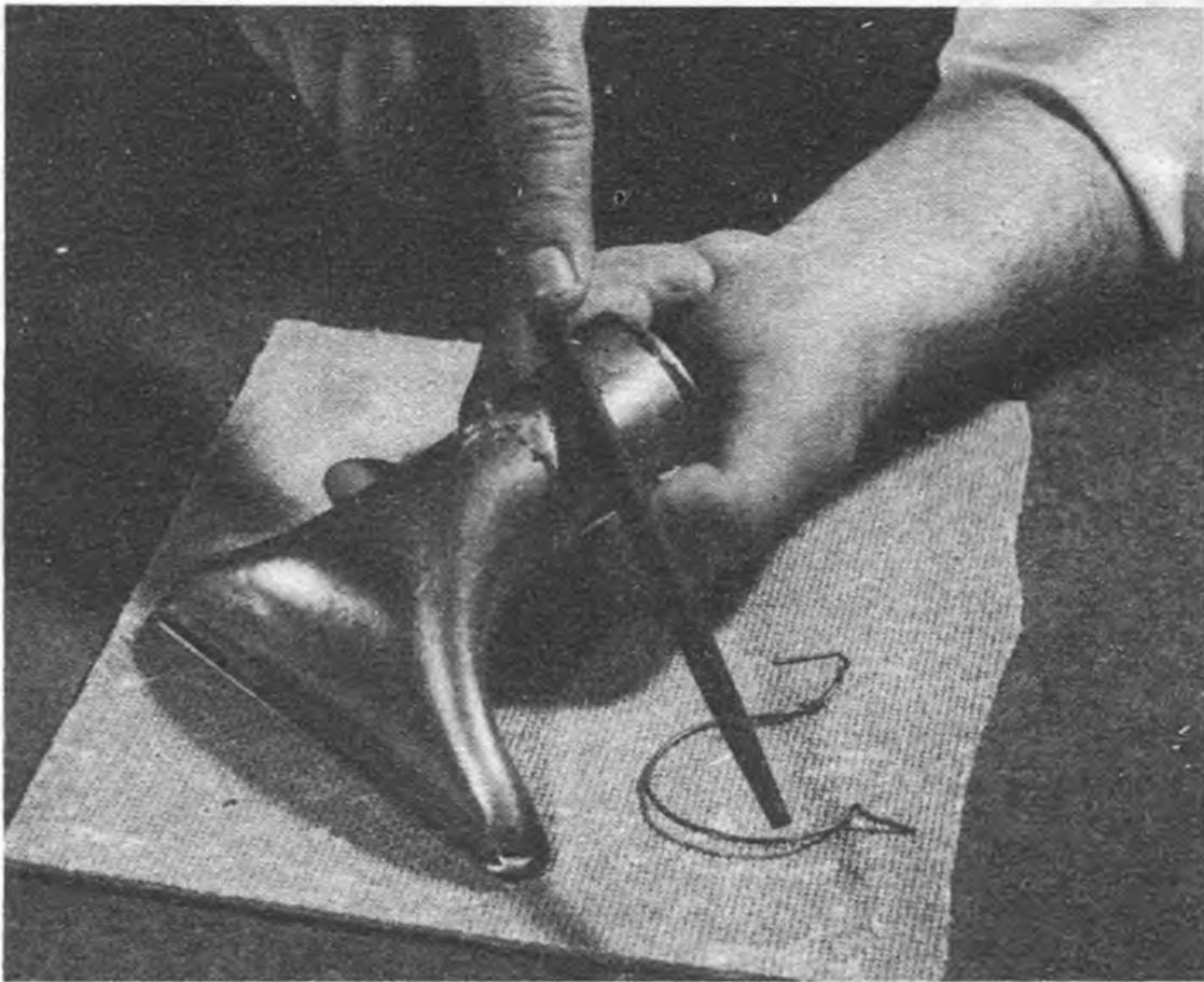
Una volta che il canalicolo a «V» sia riempito con la lega saldante e che questa vi abbia bene aderito, si toglie la legatura provvisoria, in filo di ferro e si rifilano le superfici, in modo da eliminare il materiale in eccesso, senza che venga a mancare la robustezza, essendo rimasta la lega che riempie appunto il canaletto. La riparazione, in genere, per quanto robustissima, risulta quasi completamente invisibile.
