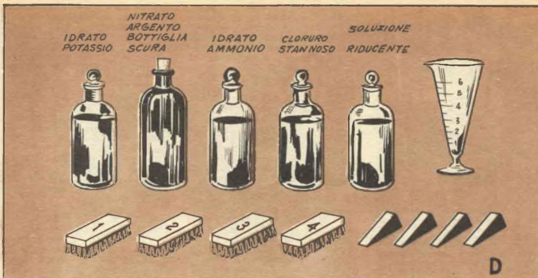
Sul tavolo sono stesi tutti gli ingredienti e tutti i materiali che occorrono. Rispettare la numerazione delle spazzole. I cunei di legno debbono essere identici.
