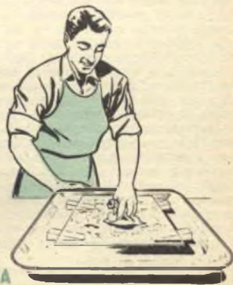
La sporcizia che si trova aderente alla superficie del vetro, viene rimossa passando su questa della polvere finissima, racchiusa in un pezzo di tela pulitissima, non molto fitta. I quattro cunei di legno, servono per facilitare il sollevamento dello specchio
