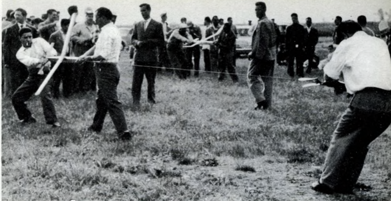
Il caricamento di un modello ad elastico di grandi dimensioni, formula Senior. Notare il forte allungamento della matassa, la posizione dell'operatore e quella dell'aiutante, che regge con due mani la barretta d'acciaio infilata nello spinotto portamatassa, per vincere la forte trazione di questa. Un altro aiutante mantiene in linea il muso della fusoliera
