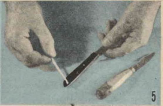
Miglioramento della durata di manici in legno di utensili di uso comune, ottenibile applicando su questi, due o più mani, via via più dense, di soluzione di cera per pavimenti.
