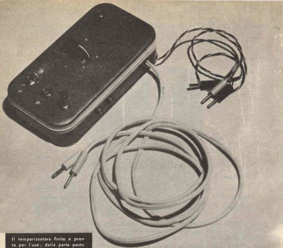
Il temporizzatore finito e pronto per l'uso; dalla parte posteriore escono il cordone per la presa di rete e le banane per l'alimentazione delle lampade di camera oscura; sempre sul retro sono le bocche per l'alimentazione della lampada dell'ingranditore.
