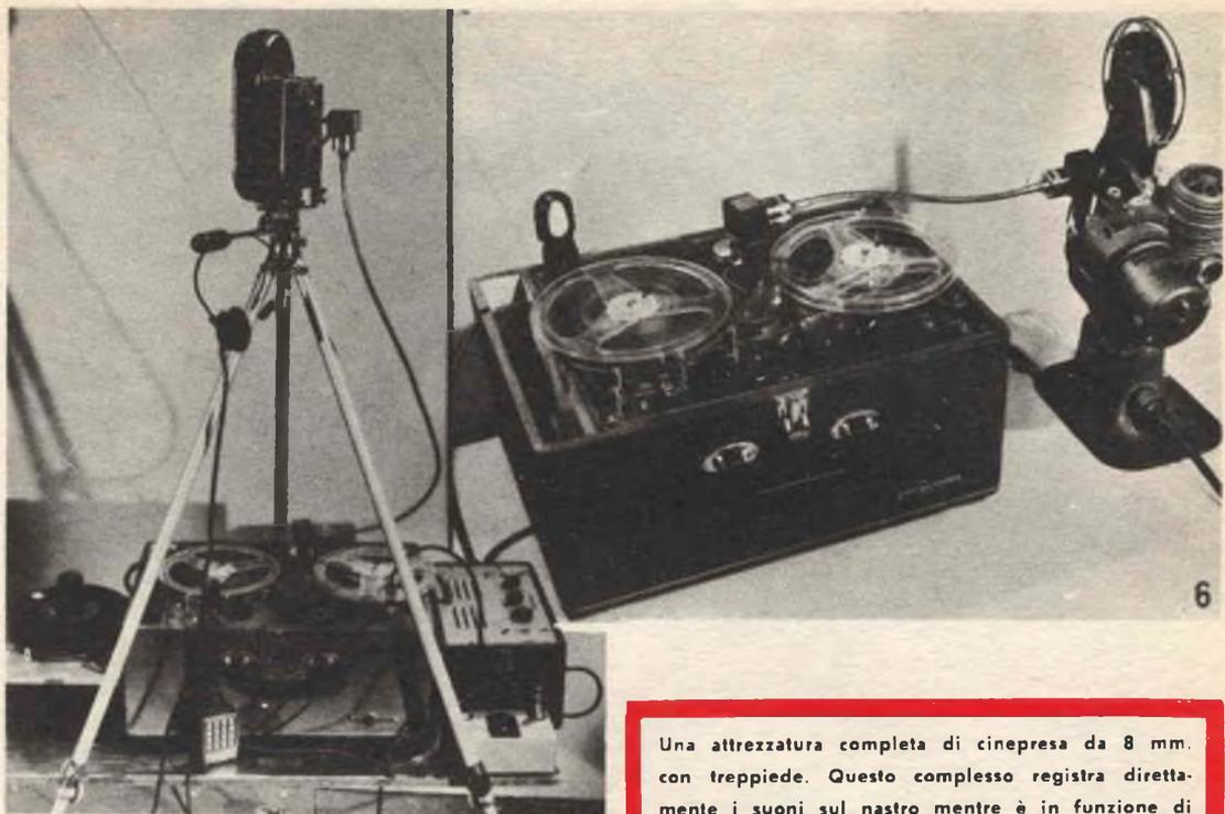
cronometrico, per mantenere la cinepresa ed il proiettore alla stessa velocità.
