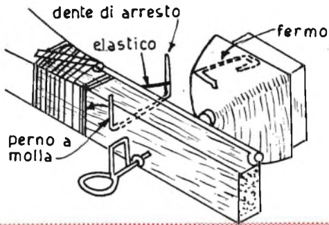
FIG. 9 - ALTRO TIPO DI ELICA RIBALTABILE CON SCATTO LIBERO
