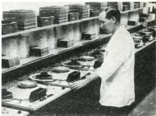
Il tavolo di montaggio costituisce l'unità di smistamento dei segnali. Il suono viene ora inciso su nastro per avere l'edizione definitiva. Da questo nastro si ricava in seguito la matrice di alluminio, che permetterà lo stampaggio dei dischi.
