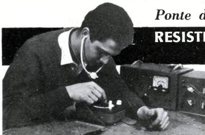
Il collaudo del ponte di misura eseguito nel nostro laboratorio con l'ausilio di una resistenza a filo di precisione. Come rivelatore si è usata una cuffia Geloso ad alta impedenza.
