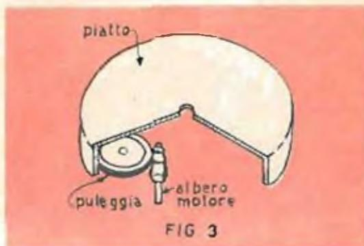
Fig. 3 - La Garrard usa il metodo tradizionale di trascinamento, tramite una puleggia a gradini e una ruota in gomma, che trasmette il movimento al piatto.
