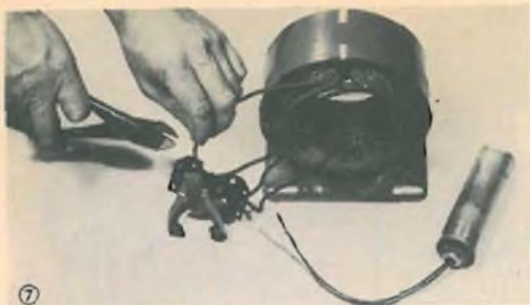
Durante l'avviamento si inserisce in serie nel circuito ausiliario un condensatore per ridurre la corrente d'avviamento. Tagliate il filo e collegato il condensatore in modo che esso si trovi in serie fra un capo della linea di alimentazione e il commutatore.
