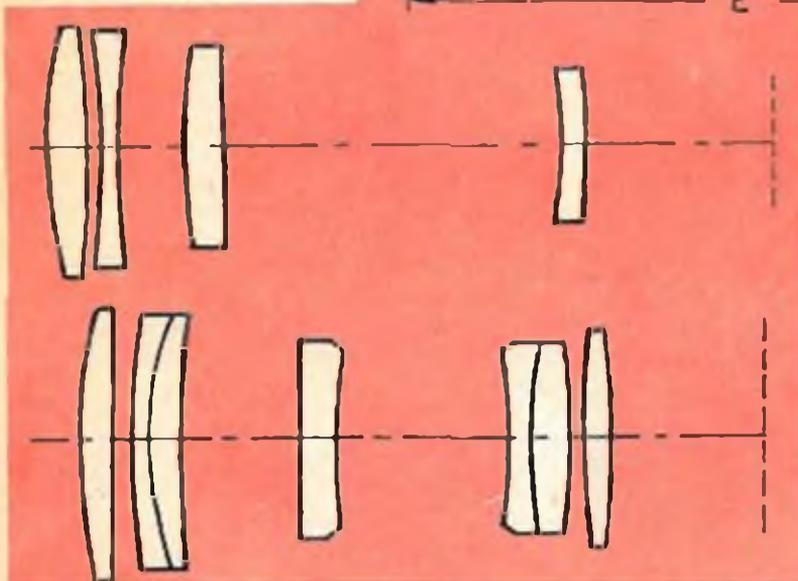
ma al piano del film (C). Il risultato è lo stesso che se il raggio fosse stato focalizzato da una unica lente (D) di lunghezza focale più lunga. La lunghezza focale effettiva del sistema (E) è perciò più grande della distanza fisica dalla lente (A) al piano del film (C).
