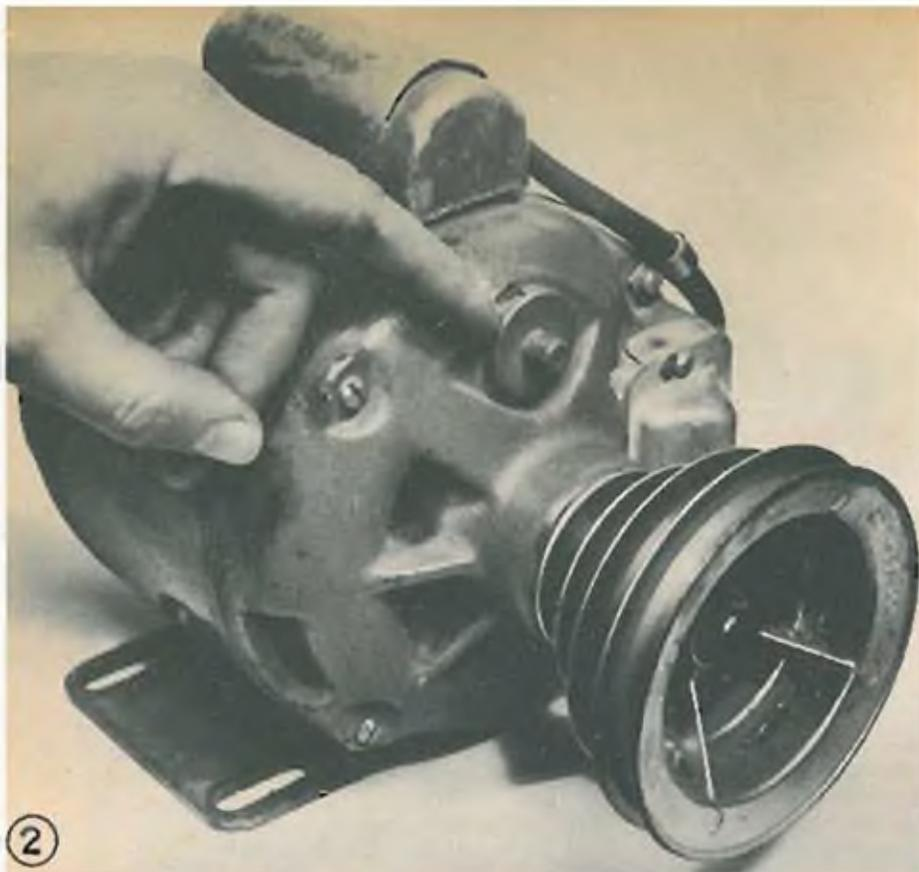
Molti motori hanno incorporati dispositivi di protezione contro sovraccarichi: in tal caso, se il motore cessa di funzionare per sovraccarico, eliminare la causa, lasciare raffreddare e premere nuovamente il bottone per la messa in marcia.
