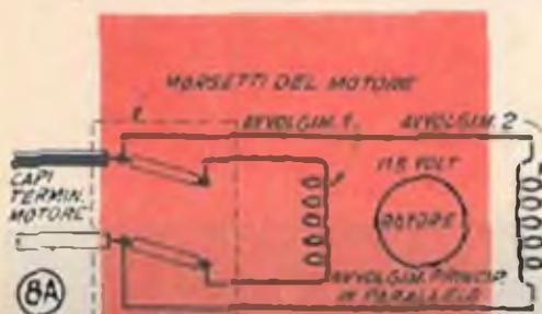
L'avvolgimento di avviamento non è indicato in questo diagramma. Gli avvolgimenti principali sono costituiti da una coppia di bobine, anziché da una sola bobina, come indicato nel diagramma.
