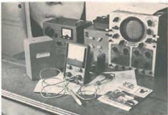
cuito chiuso (*probe* direttamente a massa) la griglia di V2A è a zero e la lancetta va a zero. Per tutti i valori intermedi di resistenze poste fra il *probe* e la massa, si hanno polarizzazioni di griglia intermedie, e quindi anche letture intermedie fra zero ed infinito.
