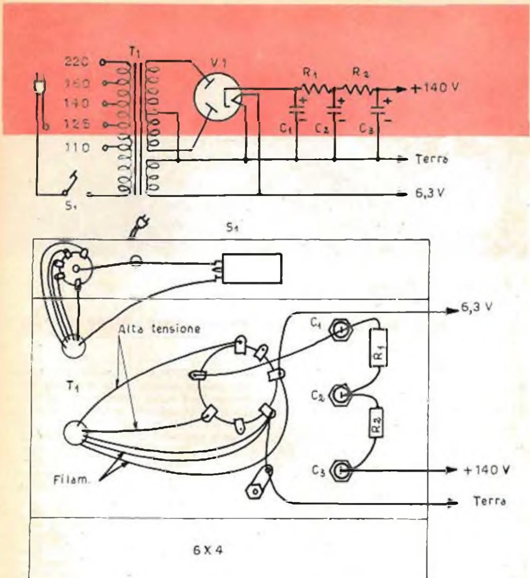
FIG. 3 - SCHEMA DELL'ALIMENTATORE
