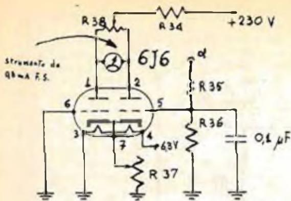
Fig. 3 SCHEMA DELL'S-METER
