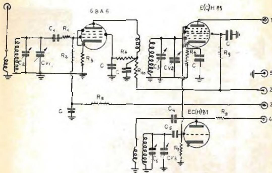
ver ultimata la costruzione del ricevitore, un circuito per misurare l'intensità del segnale captato dal ricevitore; ne riporto lo schema (fig. 3). Questo circuito non è indispensabile, ma consiglio di realizzarlo, perché consente di sintonizzare il ricevitore con precisione e di accordare con cura il circuito di entrata.
