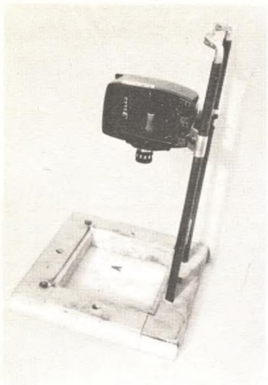
La cinepresa montata sul supporto per le distanze ravvicinate. E' visibile, sulla base dei titoli, la lastra di vetro per i titoli in trasparenza.
