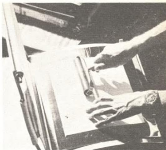
Le copie finite vengono disposte rovesciate sulla piastra della smaltatrice, e vi si passa sopra un rullo di gomma per strizzare l'acqua.
