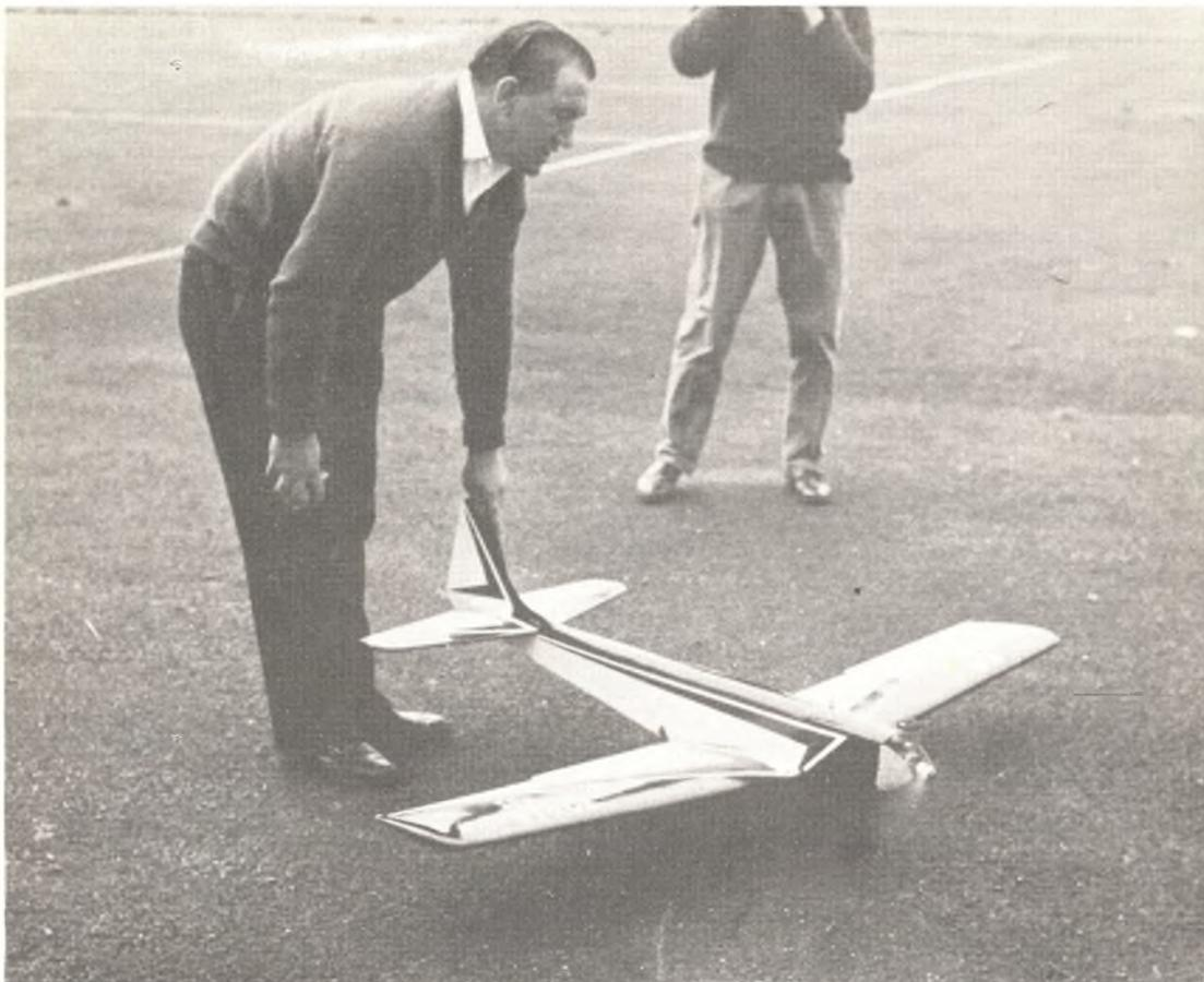
Il « Reb » di Harry Brooks, secondo classificato al Campionato Mondiale 1962, si pone in evidenza per l'uso di un motore assai potente, quale il Mc Coy 60, solitamente usato per gare di velocità. Anche questo modello ha gli alettoni sulla parte esterna delle semiali.
