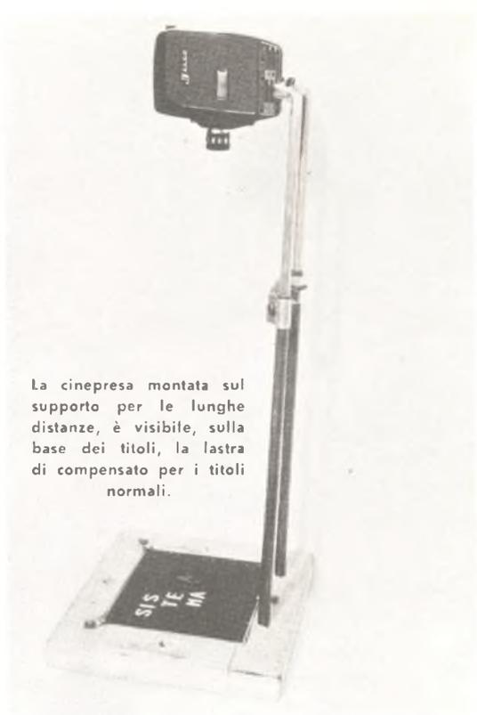
La cinepresa montata sul supporto per le lunghe distanze, è visibile, sulla base dei titoli, la lastra di compensato per i titoli normali.
