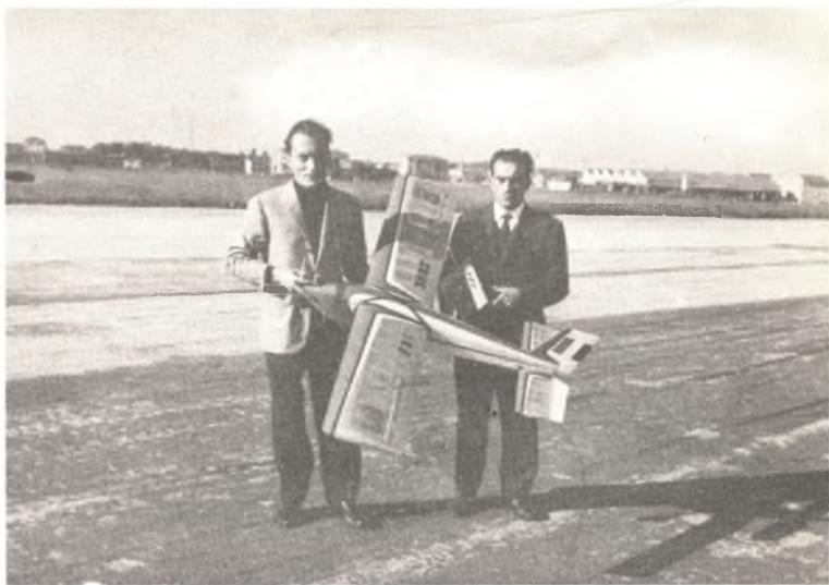
per la coda bassa, con lo stabilizzatore montato sotto la fusoliera. Manca nell'ala ogni e qualsiasi rastremazione (ragioni estetiche dice Spreng: non si poteva attaccare ad una fusoliera simile una bell'ala rastremata, perché avrebbe fatto a calci e pugni!), mentre lo stabilizzatore ne mostra proprio un barlume.
