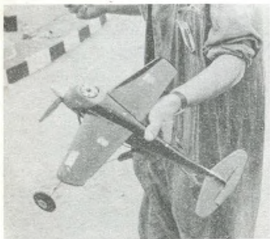
Un modello con fusoliera tipo Hell Razor, che lascia scoperta la testata del motore.
