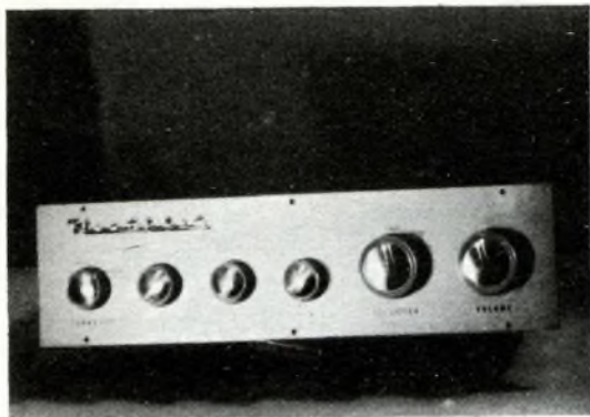
Vista frontale del preamplificatore. I comandi sono, da sinistra verso destra: turn over, roll off, toni bassi, toni alti con interruttore, selettore dei canali di ingresso e volume.
