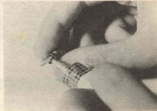
... e, dopo aver isolato con del tubetto di sterling i terminali ed aver infilato i diodi stessi dentro il contenitore, si fissa il tutto con una goccia di collante.
