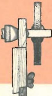
di a galletto, essi serviranno a tenere fissata in posizione la slitta di fig. 3, alla quale è affidato il compito di sostenere il trapano e di spostarlo in avanti ed indietro in modo di avanzare la punta, o arnese di taglio sul lavoro. Per fissare come detto precedentemente il trapano, dovremo preparare un castelletto a forma di culla, con dimensioni adatte a sostenerlo rigidamente.
