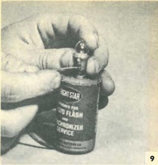
**FIG. 9** - Per provare l'efficacia di una pila, appoggiate la lampadina sul polo positivo e chiudete il circuito elettrico come in Fig. 6.
