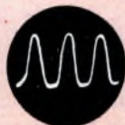
DISTORSIONE DOVUTA AL SEGNALE D'INGRESSO TROPPA FORTE
