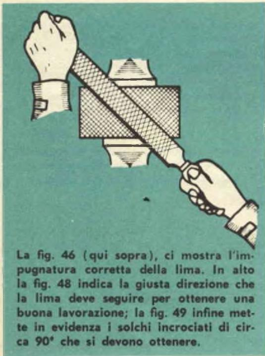
La fig. 46 (qui sopra), ci mostra l'impugnatura corretta della lima. In alto la fig. 48 indica la giusta direzione che la lima deve seguire per ottenere una buona lavorazione; la fig. 49 infine mette in evidenza i solchi incrociati di circa 90° che si devono ottenere.
