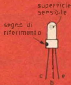
FIGG. 7-8 - L'elemento fotosensibile è un transistoro del tipo OC70 ed è collegato al circuito soltanto con due dei suoi terminali ossia il collettore (C) e l'emittore (E).
