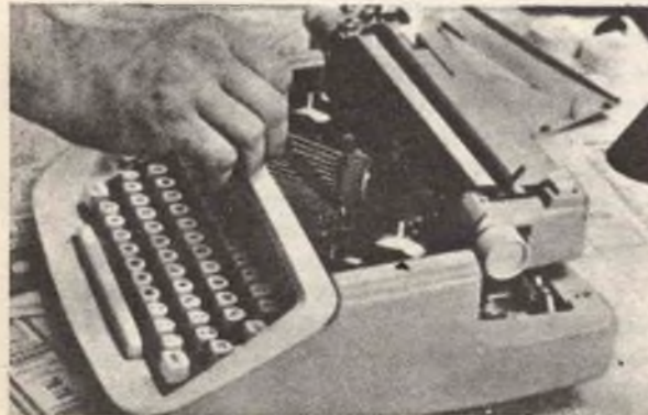
C - Applicate dell'alcool, mediante un netta-pipe, nelle fessure in cui si muovono le leve dei tasti. Quando la sporcizia è inumidita, toglietela con la limetta per le unghie.
