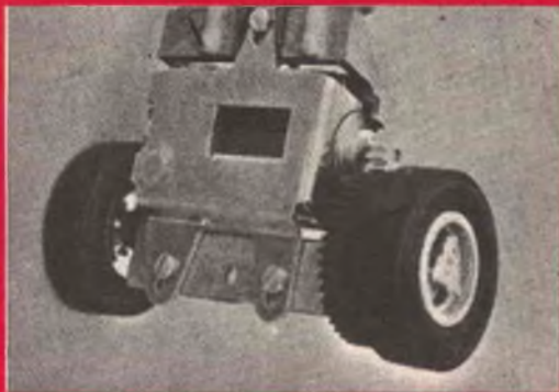
Dopo aver controllato che gli ingranaggi della trasmissione finale lavorino correttamente in tutti i punti della rotazione e siano perfettamente allineati, è opportuno lubrificarli con un leggero velo di grasso.
