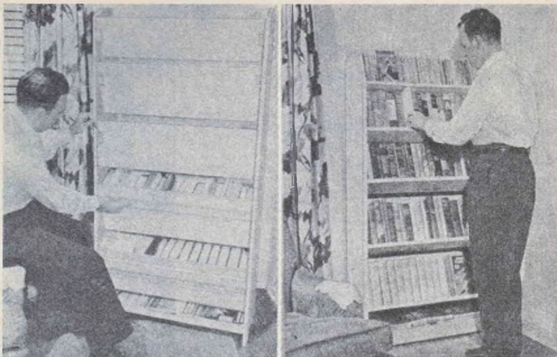
(Foto di sinistra): Il lapis che tengo nella mano sinistra è puntato con uno dei sblocchi che sostengono i tre scaffali più piccoli, ossia quelli più in alto, mentre i due scaffali inferiori, che sono più grandi, sono sostenuti da strisce intere. (Foto di destra): La ricerca di un libro. Notare come i titoli che sono sulle costole dei libri possano essere facilmente lette senza costringermi ad inchinarmi. Tendo a sottolineare che le dimensioni degli scaffali (esclusa la lunghezza), possono essere variate per soddisfare qualche preferenza personale.
