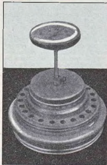
Il complesso del coperchio, comprendente il coperchio stesso, il termometro e le varie guarnizioni nonché la serie dei tre schermi e le due serie di spaziatori. Con questo tipo di termometro, l'altezza del suo elemento sensibile può essere regolata in funzione del livello del liquido contenuto nel recipiente.
