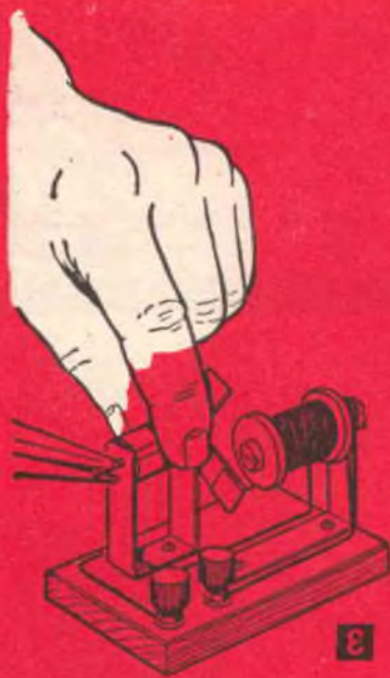
FIG. 3 - Tenendo fermo l'asse del tamburo con le pinze è possibile spostare il tamburo in una posizione tale per cui la spazzola tocca uno dei contatti quando uno dei bracci del rotore si trova nella posizione qui indicata.
