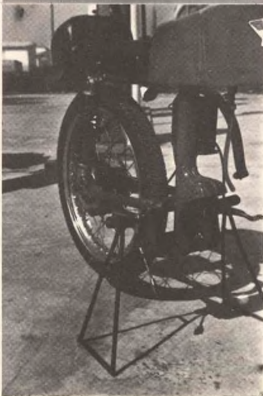
FIG. 5 - Altro particolare posteriore visto dal lato della trasmissione. Si noti la vite di fissaggio della sella, la piastra di supporto della pedaliera del cambio, il cavalletto, il rubinetto del serbatoio col tubo in plastica per il collegamento al carburatore.
