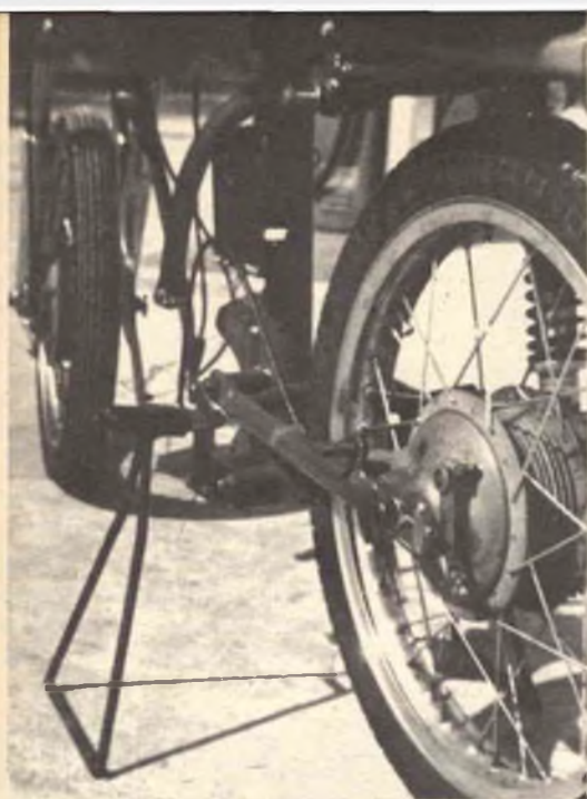
FIG. 7 - Altro particolare della sistemazione del freno posteriore e del fissaggio della ruota. Si noti la piegatura all'infuori del cavalletto di sostegno.
