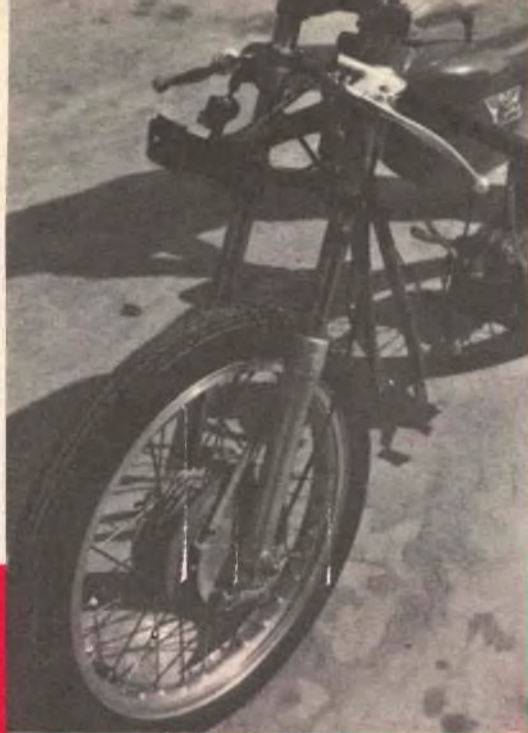
FIG. 9 - Visione della forcella anteriore denudata dei foderi. In evidenza l'asta rigida che collega la parte fissa del mozzo anteriore alla forcella.
