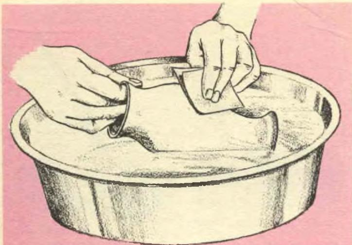
Come va condotta l'operazione della liscivatura degli oggetti prodotti qualunque ne sia la forma; occorre naturalmente della cartavetro o cartasmeriglio, del tipo resistente all'acqua di grana molto fine, quale quella del n. 4 ed inferiore. Per la lucidatura finale; si può usare un abrasivo molto fine in polvere, applicato con un tampone di lana o cotone pulitissimi, umidi
