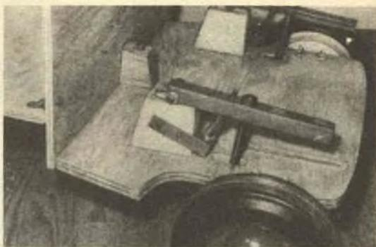
I supporti per l'albero intermedio, sono imperniati, ad una estremità, nelle apposite bronzine di banco e sono trattenuti alla giusta altezza dalla coppia di molle impegnate in basso negli appositi supporti; tali molle hanno indirettamente anche la funzione di trattenere tese le due cinghie di trasmissione. La unione delle estremità del giogo a ciascuno dei supporti per l'albero intermedio, deve essere solida e sicura, con doppi dadi.
