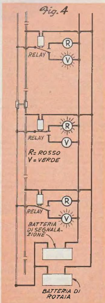
di rotaia che vi giungono sono isolati elettricamente, in maniera che tra una sezione ed una altra le rotaie stesse possano servire da veri e propri conduttori, per quanto nessuna corrente circoli tra una sezione e quelle adiacenti.
