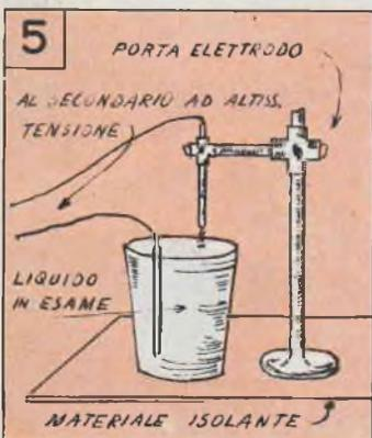
lante. Avvicinate questo elettrodo al liquido, per un attimo e quindi distaccatelo nuovamente: fra la punta dell'elettrodo e la superficie del liquido vi si accenderà la scintilla e con lo spettroscopio potrete leggere lo spettro della sostanza.
