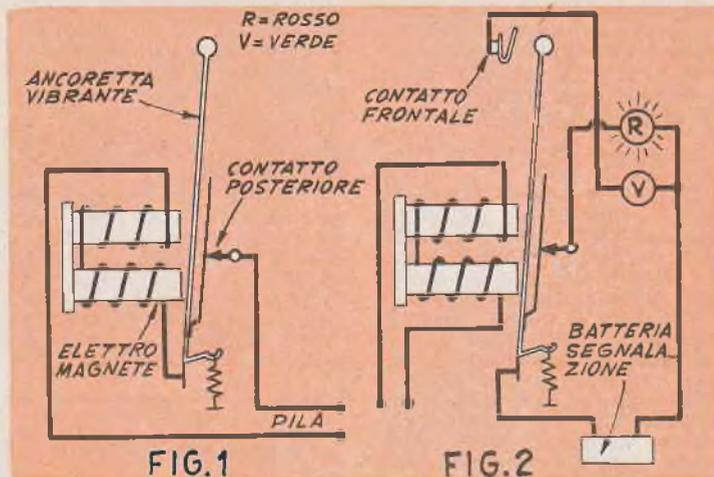
della sua stessa gravità. Nel caso invece che si tratti di un sistema di segnalazioni con lampade rosse e verdi, in luogo delle bandiere, il relay che presiede alla accensione delle lampade stesse deve trovarsi in condizione che allorché manchi la corrente, la pesante armatura mobile di esso ricada, andando a stabilire il contatto per la accensione delle lampade rosse.
