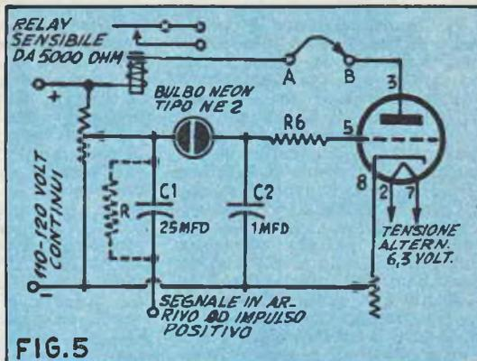
SCHEMA 4 — In questa versione semplificata, un segnale, impulso, ecc., può essere rilevato ed immagazzinato sotto forma di un relay scattato in posizione di lavoro; è evidente che ciascuno di questi circuiti è in grado di immagazzinare un solo segnale per volta e non può immagazzinarne più altri, sino a quando il precedente non sia stato « cancellato », togliendo, per un istante la corrente di alimentazione al complesso.
